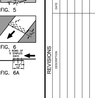
**EROSION CONTROL INSTALLATION**
